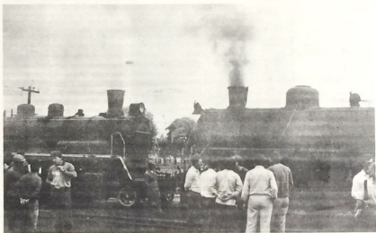
Uma locomotiva normal foi colocada ao lado da Jung adaptada para comparação dos resíduos lançados no ambiente
